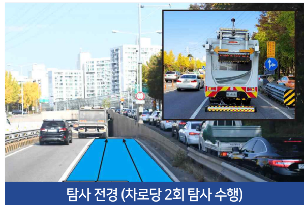
고주파수 GPR탐사 장비(2GHz), 1회 탐사 폭 1.6m
